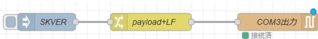
WSUHAへ送信したコマンドの応答データを受信するためのノードを構築します。
