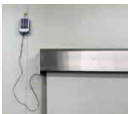
BOX部は外に設置 室内の温湿度を計測
