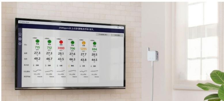
RS-WFCO2 は、温度と湿度、二酸化炭素濃度を高精度に計測するセンサーです。専用の Windows アプリを使って室内の計測値を表示、さらに WBGT 簡易推定図に基づいて熱中症リスクを表示します。熱中症リスクは 4 段階で示され、現場の状況を直感的に把握できます。
