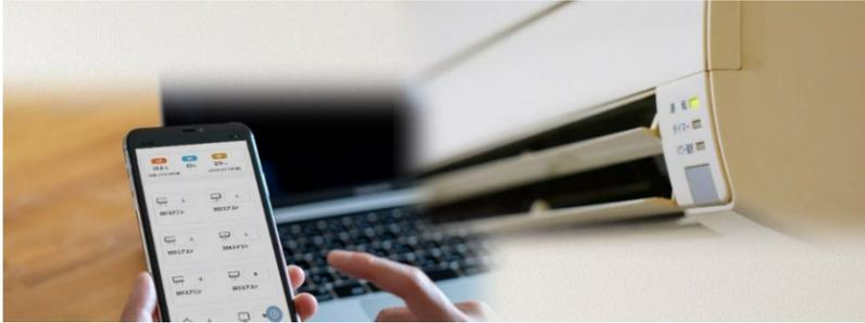
smalia（スマリア）スマートリモコンは、赤外線リモコンで操作が可能な電化製品（エアコン、工業扇、除湿器など）のIoT化を実現するデバイスです。温湿度センサーを搭載し、スマホを使った操作のほか「温度が28℃を超えたらエアコンを冷房24℃に設定」といった自動化もおこなえます。さらに、追加センサーを有人エリアに置くことで、的を絞った温湿度管理が可能になります。
